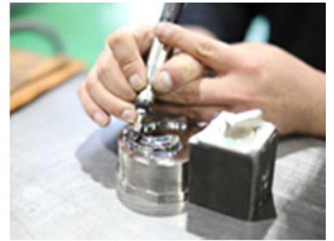
Fig. 金型の磨き加工
