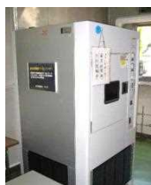
図②-1 耐光試験機 ※繊維C所有
