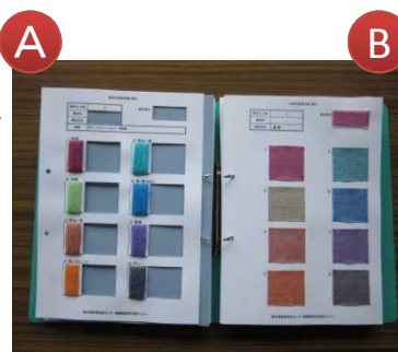
シートA：経糸（ステンシル） シートB：緯糸＋生地を貼付 A、Bを重ねて使用する
