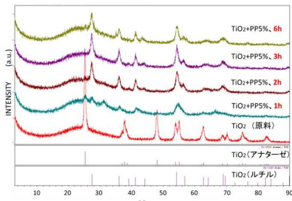
図4 メカノケミカル反応時間によるTiO<sub>2</sub>の構造変化
