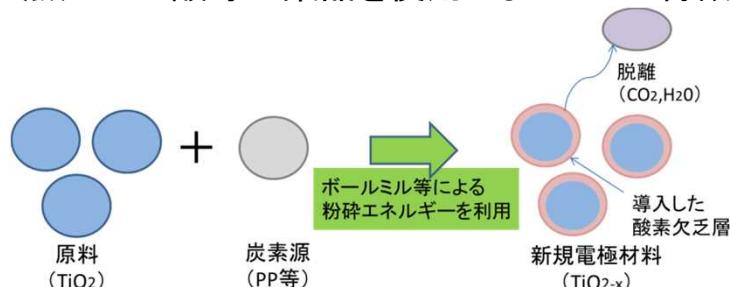
図3 メカノケミカル反応の概略図 (PP(ポリプロピレン)は還元剤としては働く)
