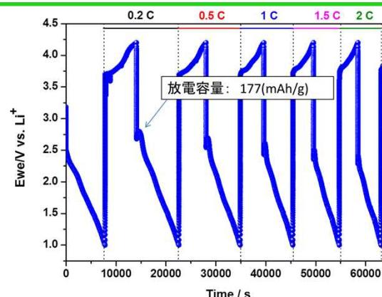
図5 試作した負極材料を搭載した電池セルの電池特性
