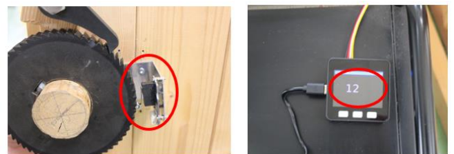
図3 スイッチ式巻取量計測機構
