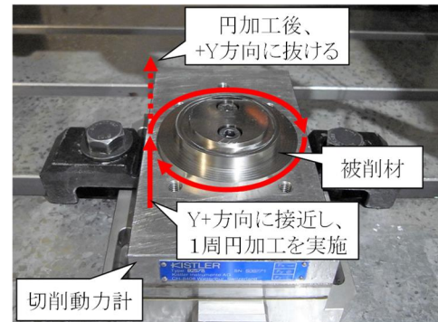
図3 円加工における切削動力計と被削材
