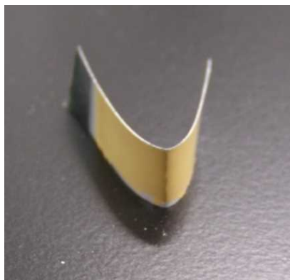
図3 アロフェン膜複合体の曲げ剥離試験
