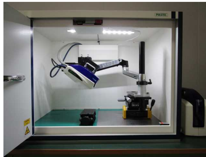
ポータブルX線残留応力測定装置
