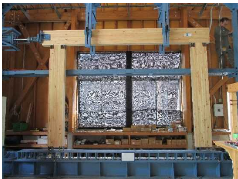
写真② 実大木造ラーメンの強度試験の様子
