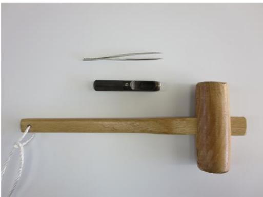
写真1 使用道具（木づち、目抜き、ピンセット）
