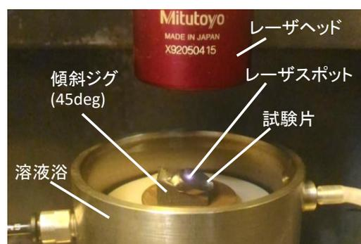
図1 傾斜面へのレーザ照射実験の外観
