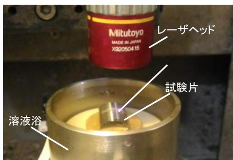
図5 円筒面へのレーザー照射実験の外観
