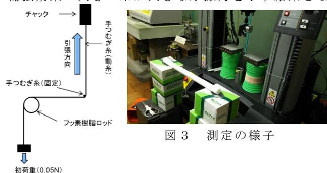
図2 摩擦力測定
