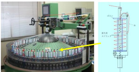
図1 トーションレース機(左)と糸供給装置(右)
