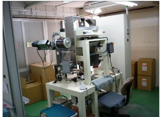
図1 試作に使用した転写印刷装置
