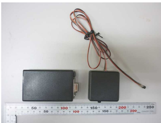
図1 改良したセンサモジュール (左:受信機, 右:送信機)
