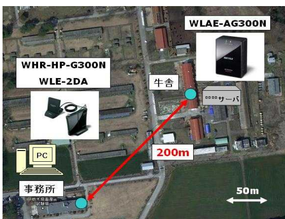
図5 事務所と牛舎間の通信経路設定
