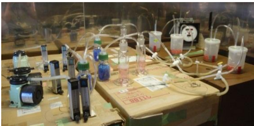
写真1 臭気発生装置を用いて資材の比較試験を行っている様子
