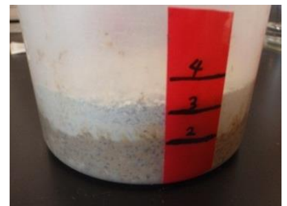
写真2 円筒容器に豚糞と資材を敷き詰めている様子 容器の大きさ （960ml 直径 9.4cm）
