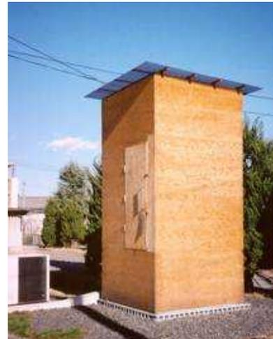
写真1 試作した太陽熱乾燥器
